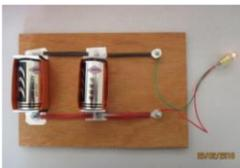
一般的な実験で、電池や電球を導線で繋ぐとき、長さがバラバラになってしまい、曲がってしまうことが多くあります。しかし、木の板にビスを取り付けることで、まっすぐに導線を結ぶことができます。電池ホルダーは厚紙で作成しています。
